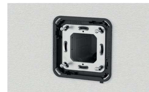
5b Unire la scatola standard commerciale e il supporto di montaggio, dopodiché fissare il telaio EKINEX con le quattro viti agli angoli
